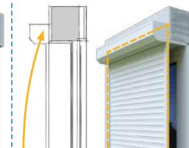
En cas de pose applique, (tablier descendu), enlever la trappe et fixer le coffre au mur. Procéder ensuite à l'étanchéité sur la périphérie du volet
